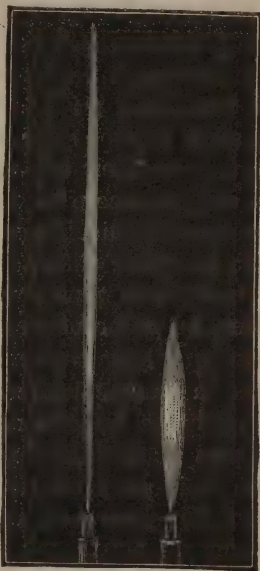
Fig. 39. — Flamme sensible. Expérience de Tyndall.
